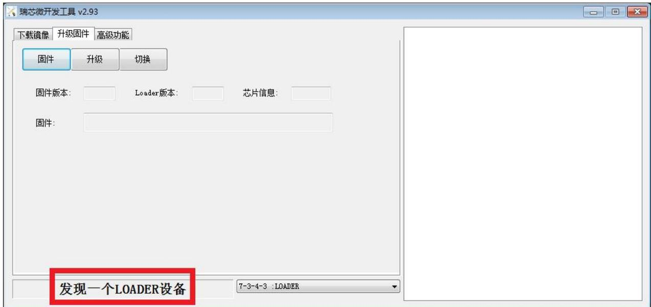
**方式一**、将主板断电，**首先用TYPE-C线将主板与PC机连接好**，按下主板上的烧写键，并保持按下状态，然后再上电开机，主板会进入Loader操作模式，注意这种方式适用于主板上的BootLoader可正常工作的情况。
