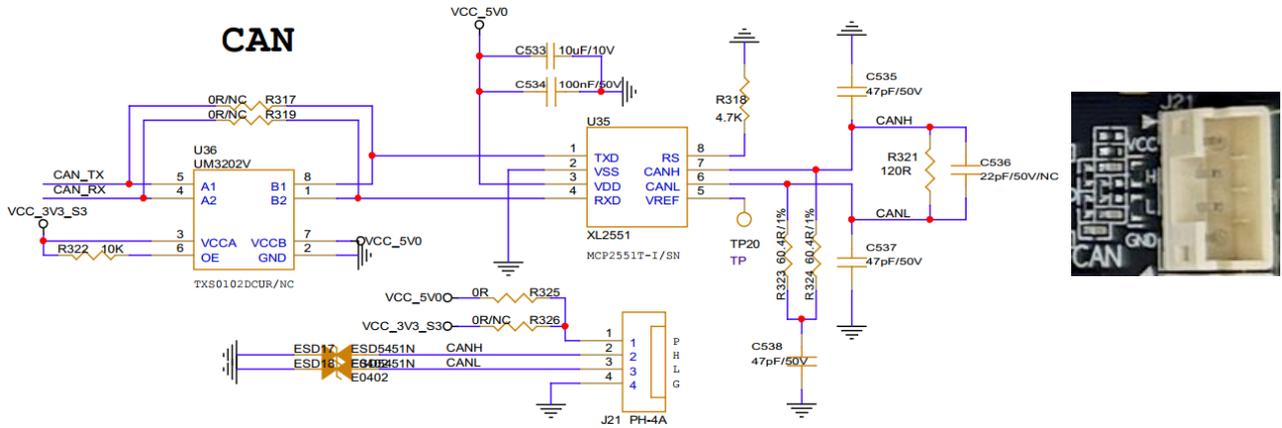
底板设计有 CAN 电平转换芯片，可直接接 CAN 设备进行通讯。
