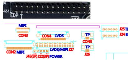
J27 双通道 LVDS 和 CON4 40Pin LVDS 接口通过底板视频转换芯片实现最大支持 1080P 分辨率，J27 可通过修改硬件电阻配置为 MIPI 输出最大分辨率支持 3840x2160，使用 J22 选择排针供电电压，J45 为 12V 特殊显示屏供电，为了系统安全 J45 默认未焊接排针，如果需要使用需自行焊接，使用 J45 时注意需要断开 J22 上上跳线帽，否则会烧坏 CPU。背光接口 J24 为通用 6Pin 接口，可以接大屏的背光驱动板。
