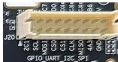
这个接口共引出 2 组 I2C 号，1 个 UART 串口，1 个 SPI 接口，以及 GPIO 接口
