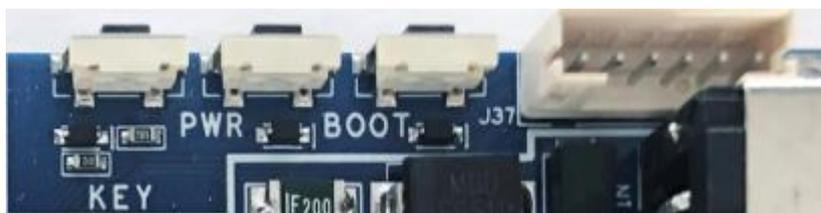
Power 键可以实现长按强制硬关机（系统死机无法自动复位时使用），Boot 键可以用于系统强制烧写。J37 引出相关按键信号，客户可根据以下参考设计自主进行外接按键板设计。
