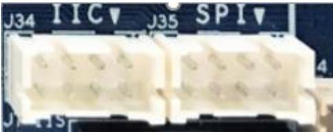
J34 引出两路 I2C 接口，其中 I2C0 连接有触摸屏数据量较大，建议外设优先使用 I2C1 通道；1 脚和 7 脚为 GPIO，可通过软件配置为输入或输出模式；2 脚为电源输出，默认 5V，可通过修改电阻配置为 3.3V 输出
