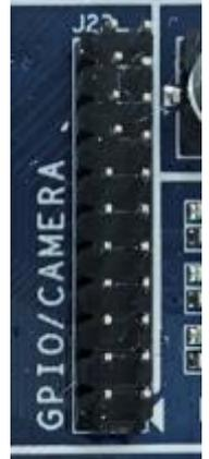
15 路 GPIO，可以配置为输出或输入模式，高电平为 3.3V，2 脚默认输出 3.3V，4/6 脚默认输出 1.8V 电源
