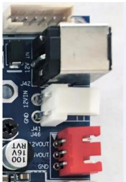
主板电源输入为 12V，J42 为标准 2.5\*5.5 电源座，J41 为 3.96 电源输入座，J46 为 12V 和 5V 电源输出接口
